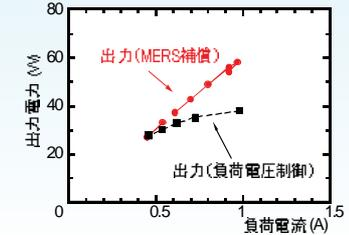
MERSで補償することで出力をフラットに補償し、一定制御を達成
